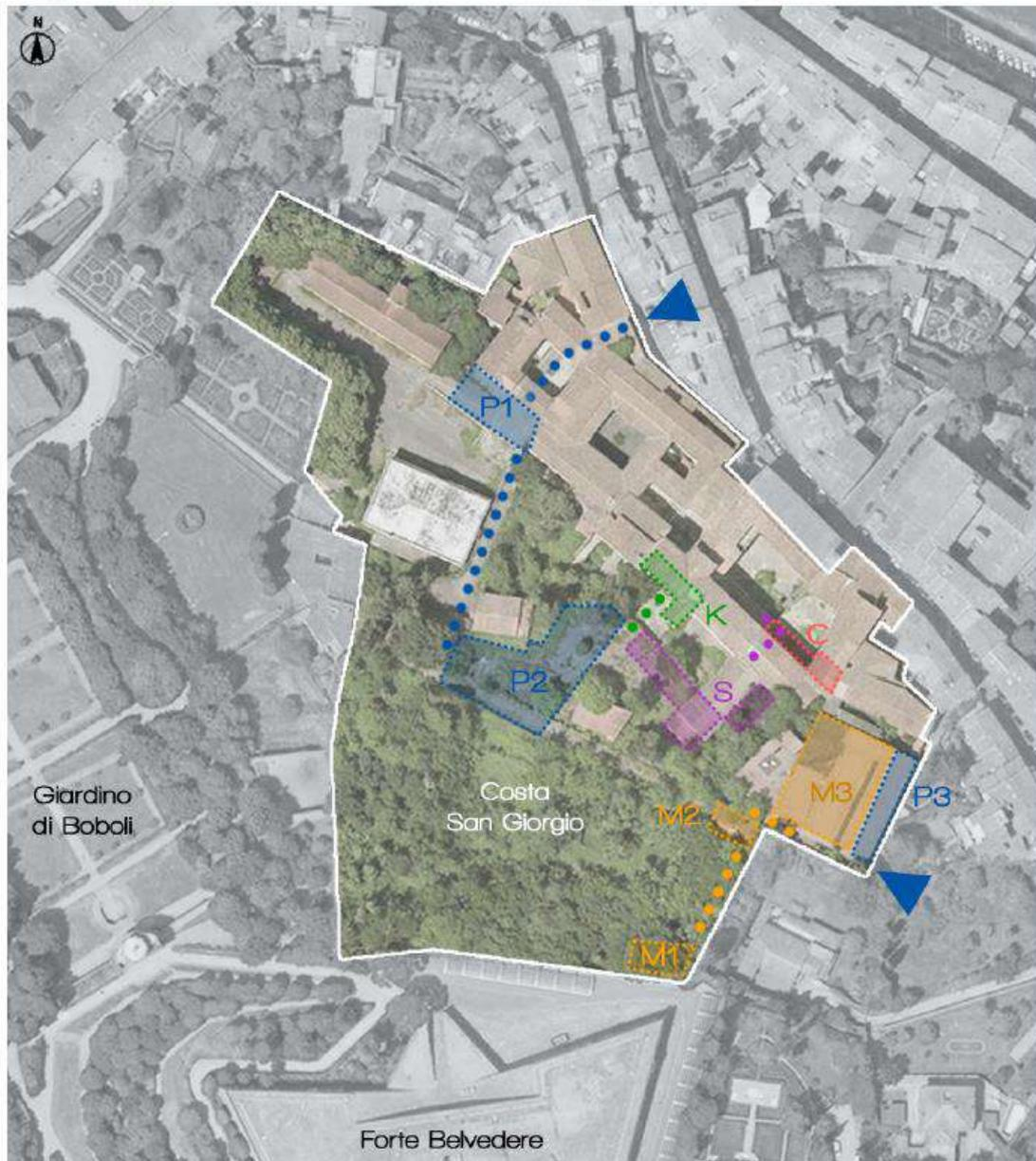
Fig.1 – planimetria del complesso e dell'area di pertinenza con evidenziate le zone dove sono previsti interventi di scavi per la realizzazione di vani interrati.
